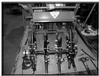
Fig.16 Rimuovere completamente il rotore e metterlo da parte con la catena di trasmissione e gli altri componenti per la reinstallazione.
