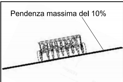
Diag.1: Aerazione sul posto inclinato
