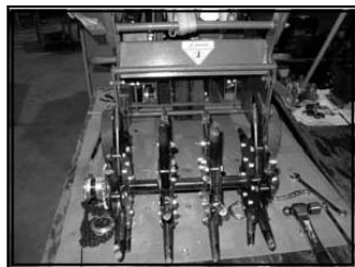
Fig.16 Supprimez complètement le rotor et le mettez de côté avec la chaîne d'entraînement et d'autres composants pour réinstallation
