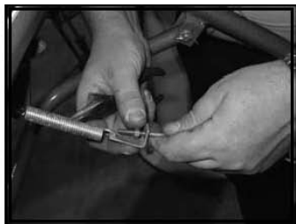
Fig.14: Réglage de tension de la courroie sur le cable d'embrayage
