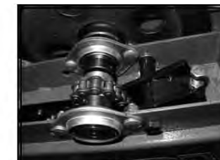
Fig.7: Desserrez le boulon tendeur et le contre-écrou
