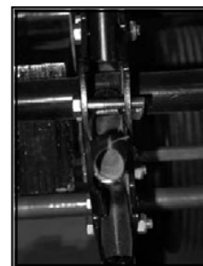
Fig.5 Posizionamento sbagliato del bullone
