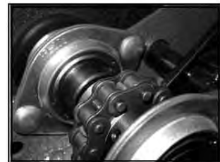
Bild 9 Kette um obere Kettenrad fallen lassen
