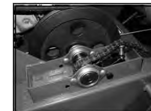
Fig.8: Desserrez le boulon tendeur et le contre-écrou dessus
