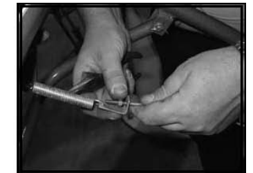
Bild 14: Einstellen der Riemen Spannung am Kupplungsseil
